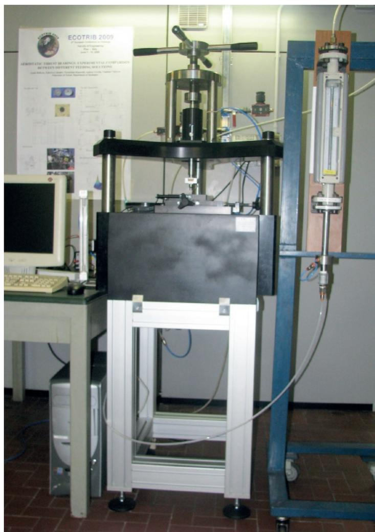
Fig. 3 – Banco di prova per pattini piani (Politecnico di Torino).
