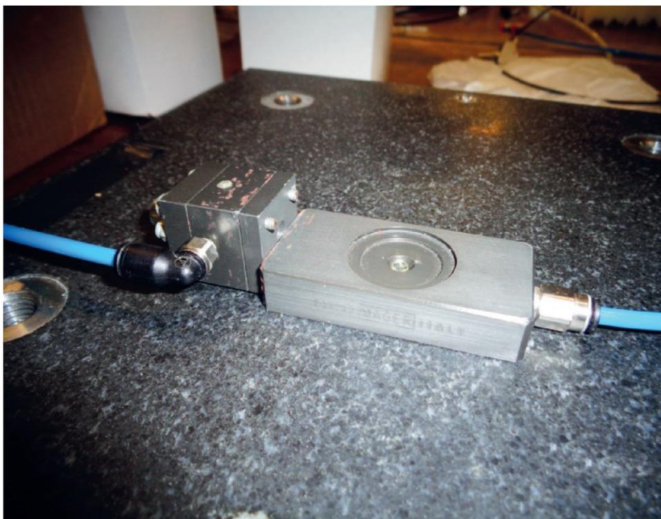
Fig. 2 – Pattino pneumostatico con valvola a membrana (Politecnico di Torino).
